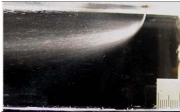
Figura 2.6 - Jato transversal injetado na garganta do Venturi.
