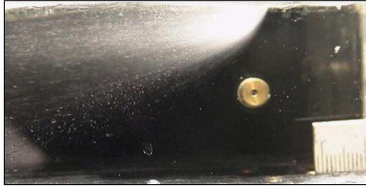
Figura 4.11 – Imagem do jato para injeção através de 1 orifício  $V_g = 59$  m/s e  $Q_l = 300$  mL/min.
