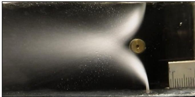
Figura 4.15 – Imagem dos jatos para injeção através de 2 orifícios  $V_g = 59$  m/s e  $Q_l = 1100$  mL/min.
