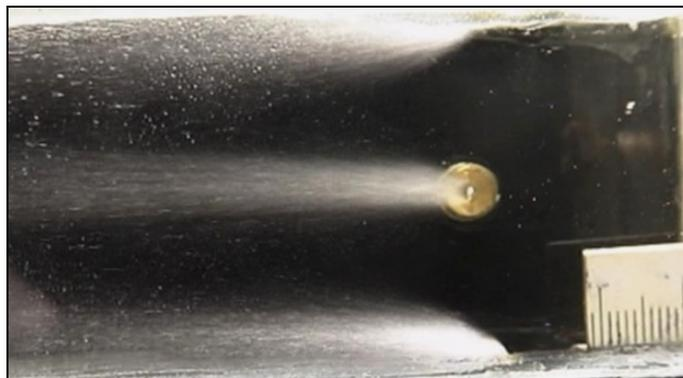
Figura 4.18 – Imagem dos jatos para injeção através de 3 orifícios  $V_g = 59$  m/s e  $Q_l = 600$  mL/min.
