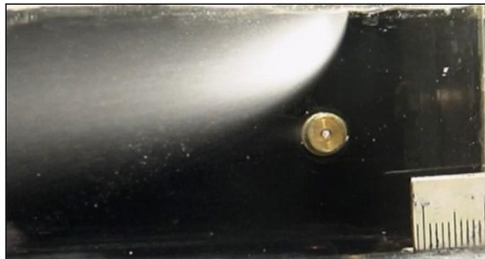
Figura 4.13 – Imagem do jato para injeção através de 1 orifício  $V_g = 74$  m/s e  $Q_l = 600$  mL/min.
