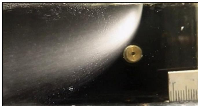
Figura 4.12 – Imagem do jato para injeção através de 1 orifício  $V_g = 59$  m/s e  $Q_l = 600$  mL/min.
