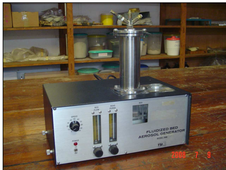
Figura 3.3. Gerador de pó do tipo leito fluidizado de pequena escala modelo TSI 3400.
