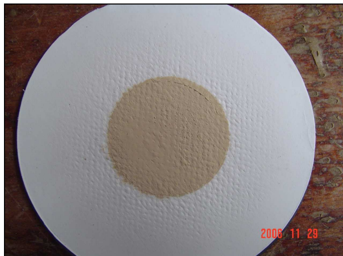
Figura 4.25. Fotografia do filtro de microfibras de quartzo após ensaio de filtração (duração de 60 min).
