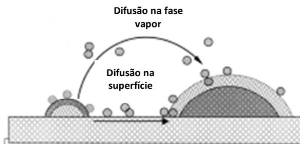
**Figura 2.3:** Ilustração do crescimento da partícula metálica, segundo mecanismo de Ostwald-Ripening, proposto por Lai e Goodman [45].
