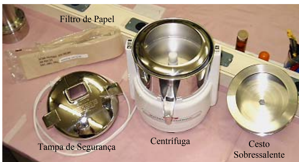
Figura 6.6: Centrífuga de cesto e suas partes constitutivas.
