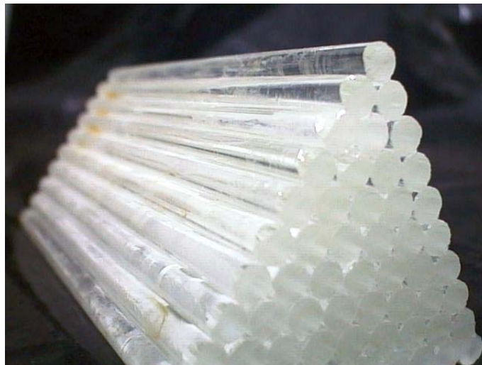
Figura 3.1. Foto dos bastões de vidro colados.
