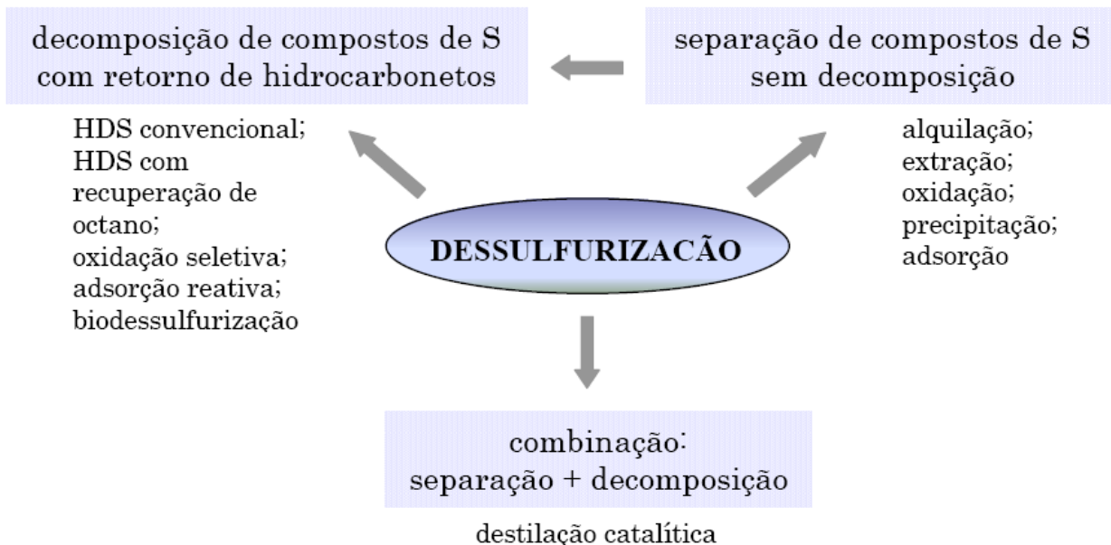
Figura 2.2 - Classificação dos processos de dessulfurização baseada na transformação dos compostos orgânicos de enxofre (BABICH e MOULIJN, 2003).
