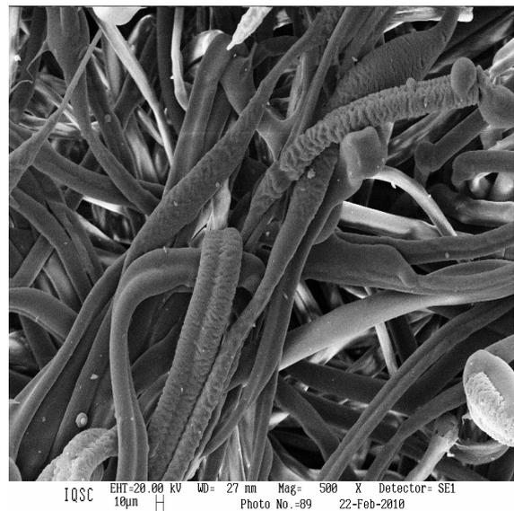
Figura 2.7: Ilustração da superfície de um filtro com estrutura não trançada (Feltro).
