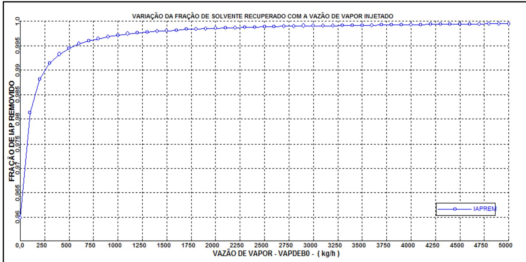
Figura 38: Análise de sensibilidade para avaliar a variação da fração de solvente (IAP) recuperado em função da vazão de vapor (VAP-DB) injetado no EVAP-DB
