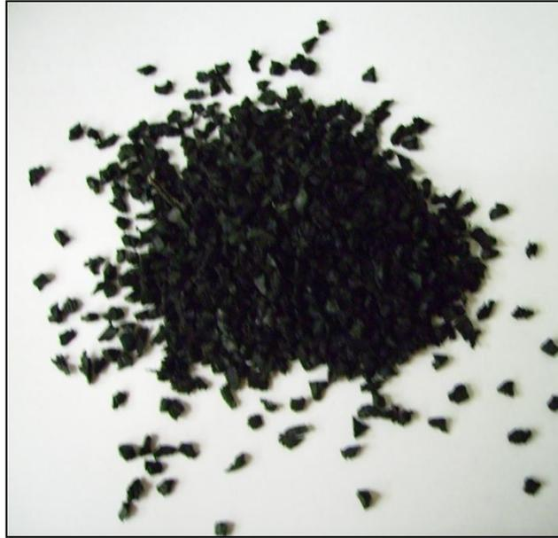
Figura 4.3 – Partículas de pneu triturado para utilização como suporte para imobilização da biomassa.
