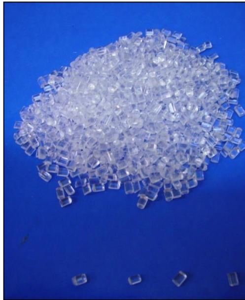
Figura 4.2 – Partículas de poliestireno para utilização como suporte para imobilização da biomassa.
