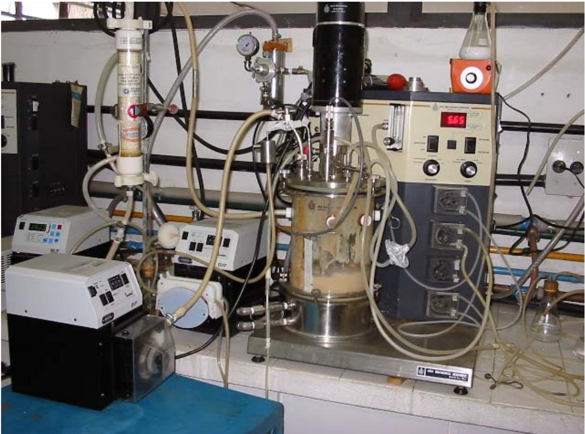
Figura 3-13: Fotografia de um experimento contínuo com reciclo celular
