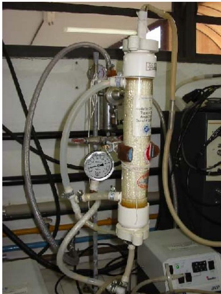
Figura 3-5: Fotografia do módulo de microfiltração utilizado nos cultivos contínuos com reciclo celular
