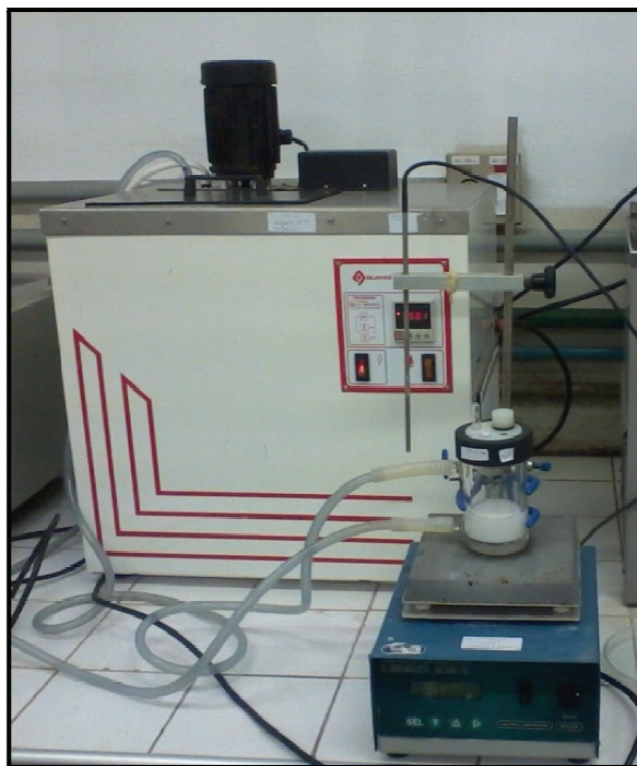
FIGURA 29 – Sistema de reação utilizado na avaliação catalítica para transesterificação.
