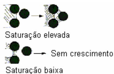
Figura 2.11 – Limites de saturação para crescimento de aglomerados (SIMONS & FAIRBROTHER, 2000).
