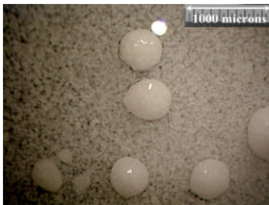
Figura 6.8 – Aglomerados observados em 67% da turbidez relativa no Ensaio B - 75 minutos.
