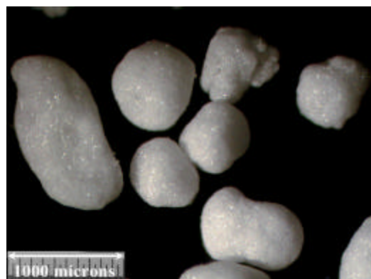
Figura 5.59 – Aglomerados com diâmetros médios de 545 microns, obtidos em concentração de sólidos de 455 \text{ mol/m}^3 .
