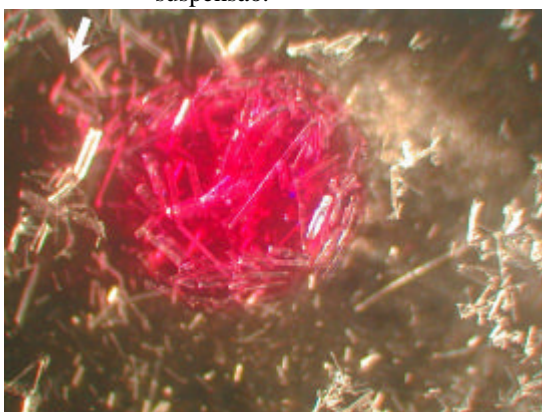
Figura 6.14 – Evaporação do clorofórmio do aglomerado.
