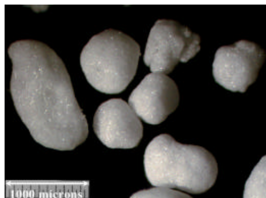
Figura 5.24 – Aglomerados típicos com tamanho médio de 545 microns (25°C).
