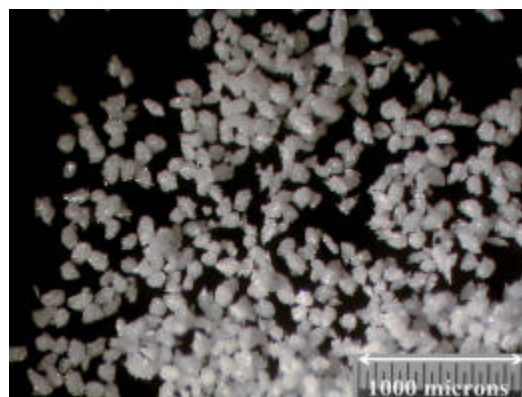
Figura 5.16 – Aglomerados típicos com tamanho médio de 50 microns (25°C).
