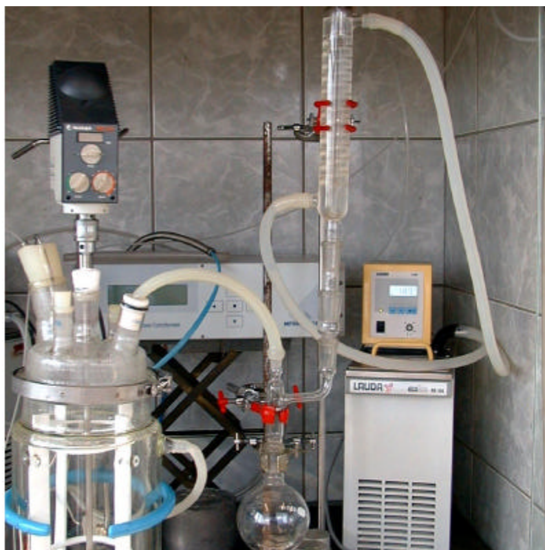
Figura 5.1 – Sistema para retenção do clorofórmio da corrente de saída de nitrogênio do reator.
