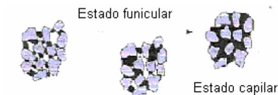
Figura 2.3 – Preenchimento da porosidade interparticular pelo agente molhante – Estados funicular e capilar (GOLDSZAL & BOUSQUET, 2001)
