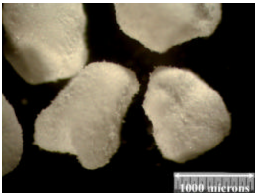
Figura 5.27 – Aglomerados típicos com tamanho médio de 920 microns (7°C).
