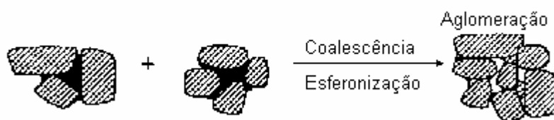
Figura 2.14 - Modelo de aglomeração em um sistema supersaturado com ponte líquida (IKEGAMI et al., 2003).
