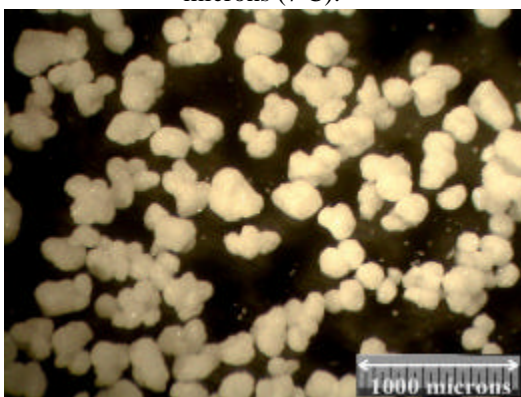
Figura 5.19 – Aglomerados típicos com tamanho médio de 195 microns (7°C).
