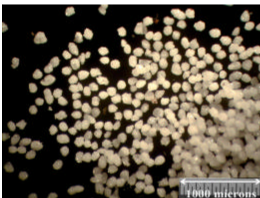
Figura 5.15 – Aglomerados típicos com tamanho médio de 50 microns (7°C).
