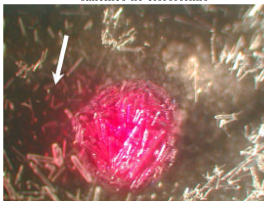
Figura 6.15 – Compactação dos cristais de ácido salicílico pela evaporação do clorofórmio.
