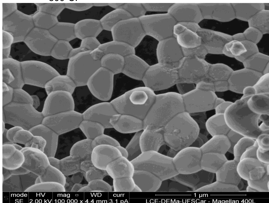
Figura 68 – Micrografia do catalisador antes teste catalítico da amostra 20\text{LaCoO}_3/\text{ZrO}_2 método deposição-precipitação calcinado a 800^\circ\text{C} .
