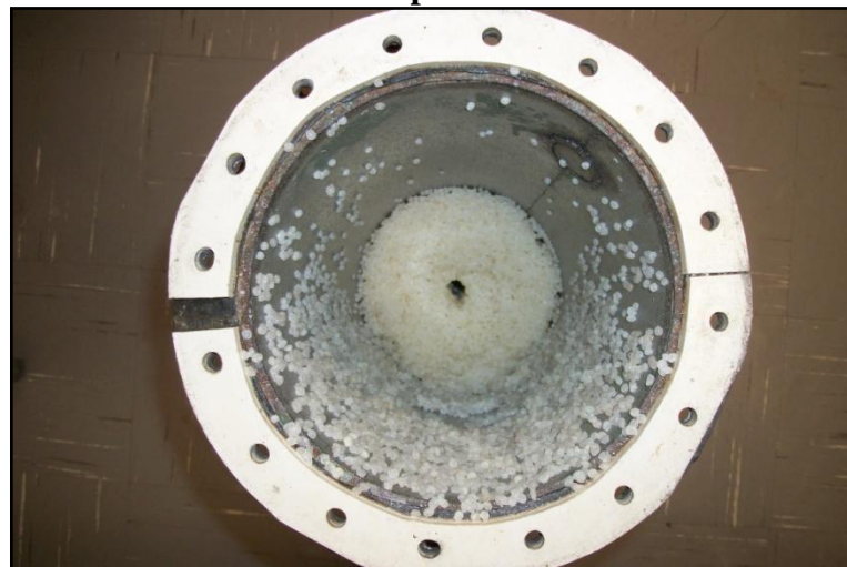
Figura 2.22 – Fotografia do leito de jorro após o colapso, com alimentação de 30 mL/min de pasta.
