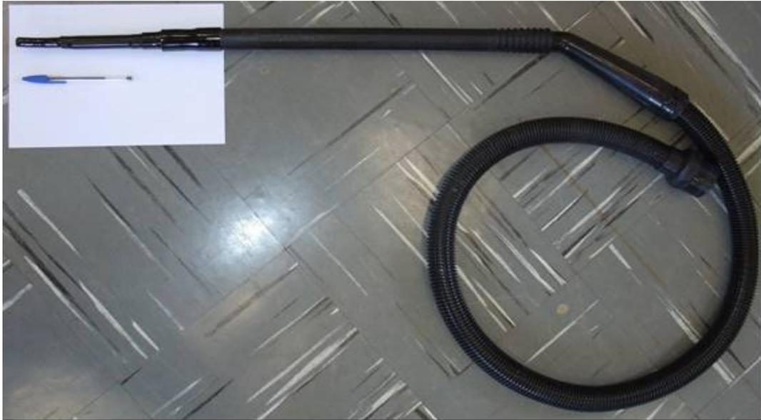
**Figura 3.7:** Fotografia do tubo de sucção adaptado, fixado à mangueira de conexão que é ligada ao aspirador de partículas.
