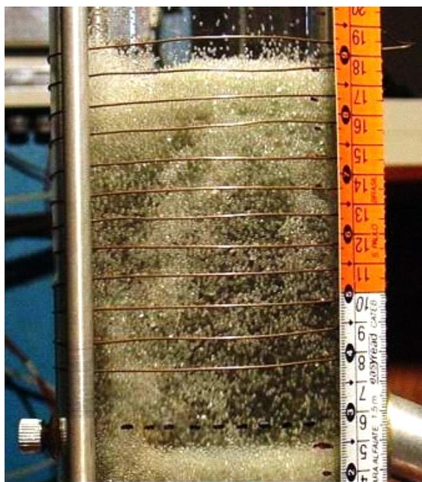
**Figura 3.6:** Fotografia do leito vibrofluidizado com o fio de cobre aterrado circundando o leito, minimizando as cargas eletrostáticas.
