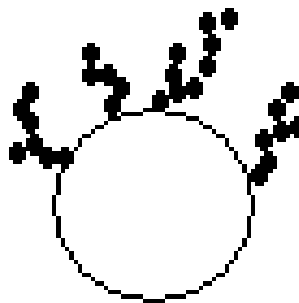
Figura 2.1: Representação esquemática da formação de dendritos
