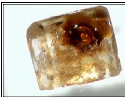
Figura 22: Inclusão de licor-mãe em cristal de sacarose (HINKOVA et al., 2002)
