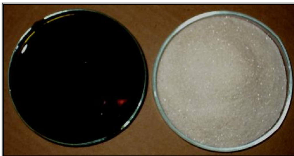
Figura 52: esquerda : xarope industrial de VVHP (cor 8600 UI); direita : açúcar obtido - ensaio 6 – xarope de VVHP- semeado (cor 390 UI)
