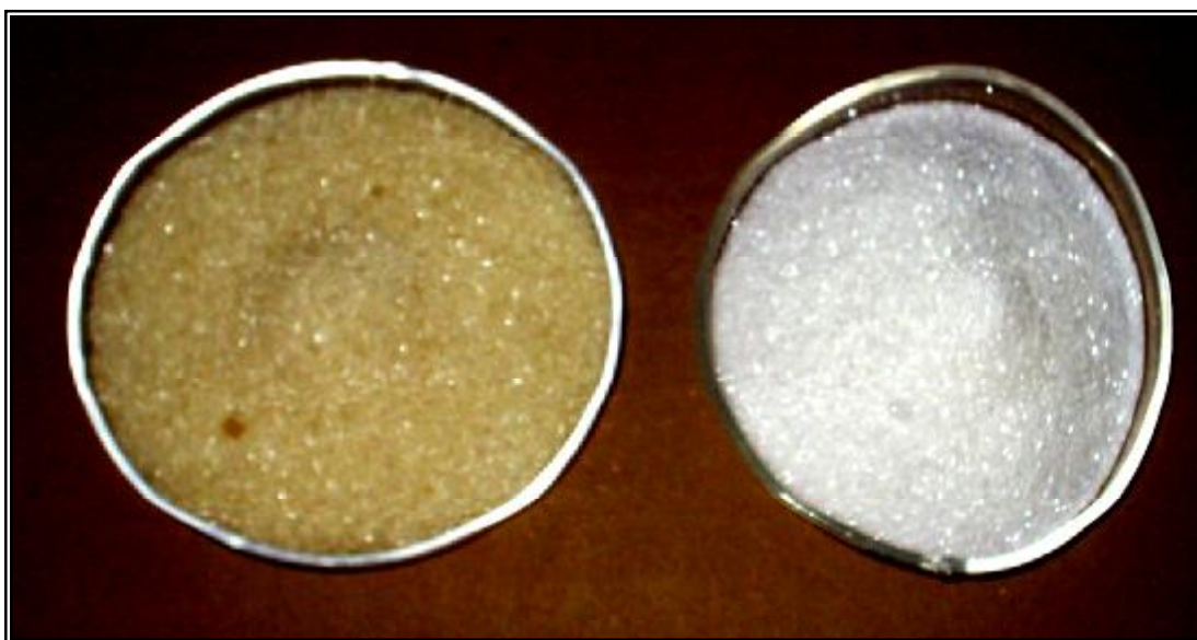
Figura 46: esquerda : amostra de VVHP original (cor 310 UI); direita : açúcar original dissolvido e recrystalizado - ensaio 5 - açúcar VVHP - semeado (cor 14 UI)
