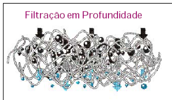
Figura 2.10: Ilustração da Filtração de profundidade (Renner Têxtil Ltda, 2001).
