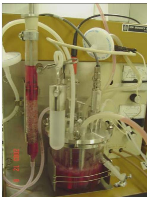
Figura 5.3 – Biorreator de leito fixo e reservatório de meio de cultura em operação.
