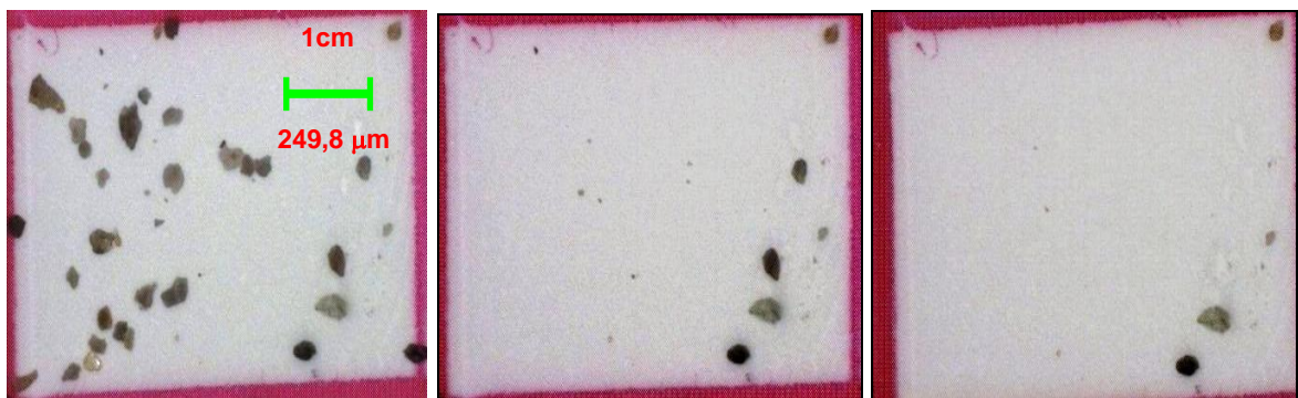
Figura 3.11: Partículas aderidas na membrana após serem aplicadas velocidades de: compressão de (a) 500 rpm e desprendimento de (b) 3000 rpm e (c) 14000 rpm.
