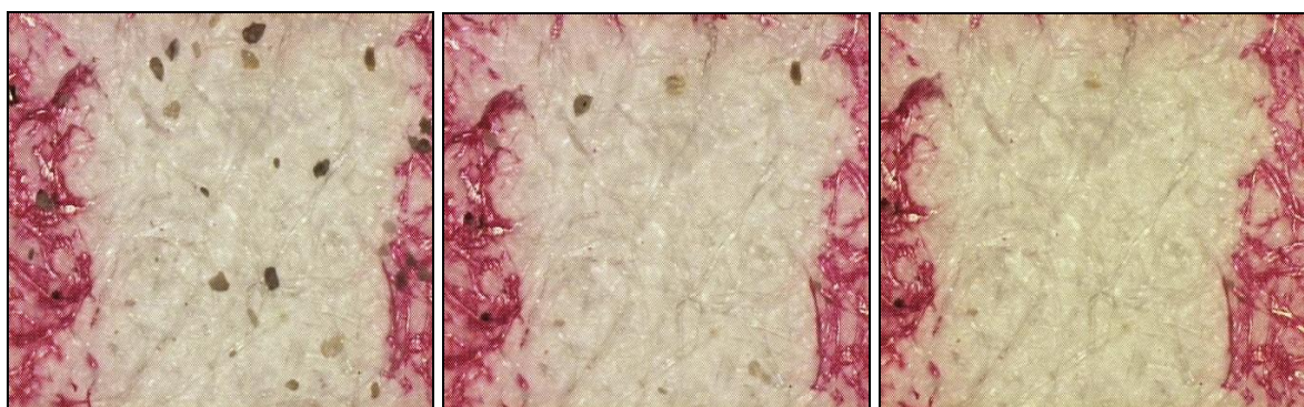
Figura 3.12: Partículas aderidas no filtro de papel após serem aplicadas velocidades de: compressão de (a) 500 rpm e desprendimento de (b) 5000 rpm e (c) 9000 rpm
