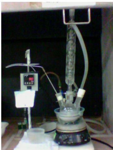
Etapa 1 - Sistema reacional otimizado: fase inicial com solução etanólica de ATB (1:0,01) e adição da água pré-aquecida a 90°C
