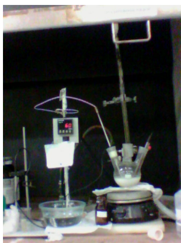
Etapa 2 - Sistema reacional otimizado: fase de adição Mg(OCH_3)_2 resfriado a 60°C
