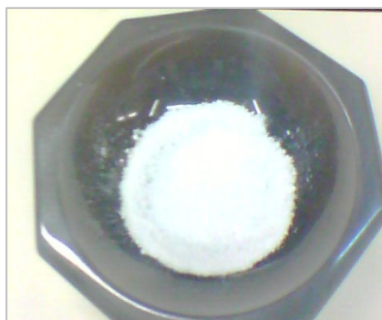
Etapa 6 - Material pronto para moagem e peneirado a 100 mesh
