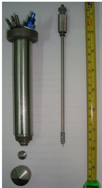
Figura 3.4: Bocal atomizador duplo fluido e seus componentes.
