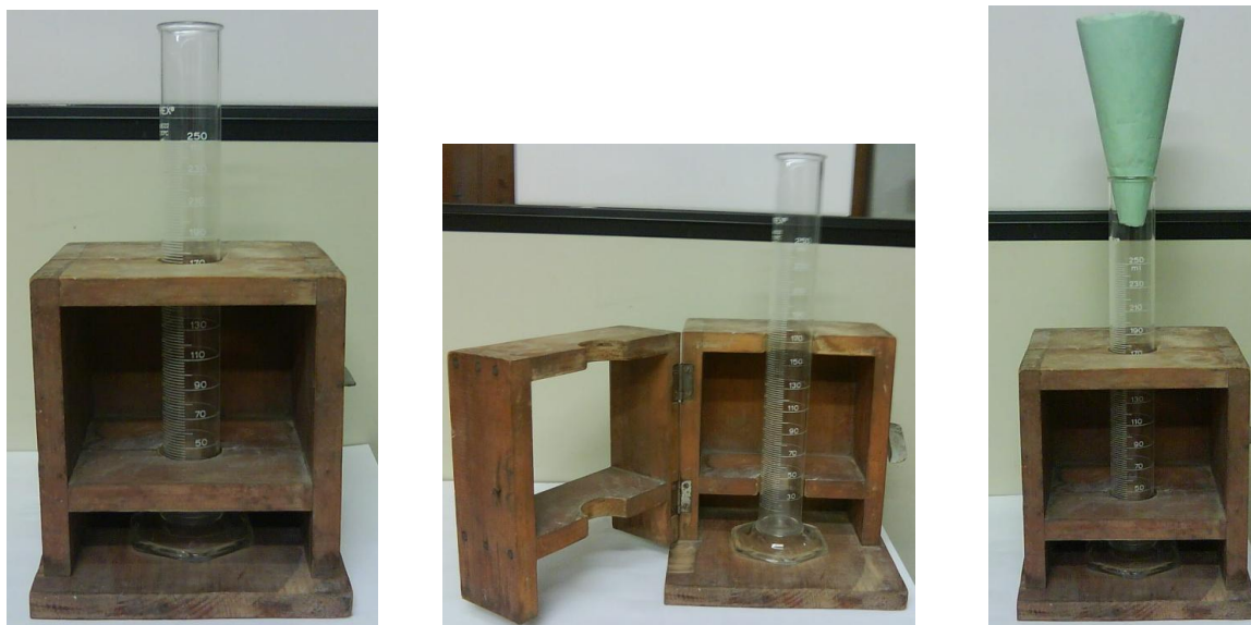
Figura 3.1: Dispositivo de madeira utilizado para a compactação padronizada dos pós.
