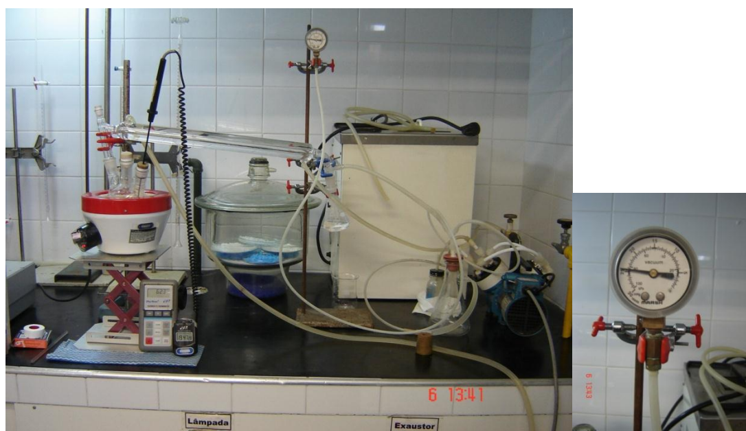
Figura 12: Arranjo experimental de evaporação a vácuo.
