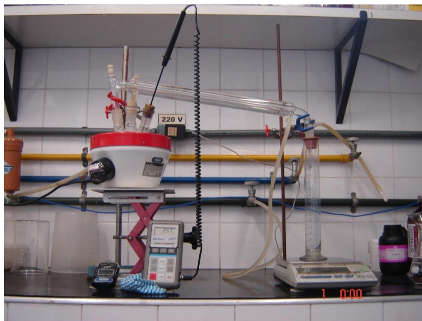
Figura 11: Arranjo experimental de evaporação a pressão ambiente.
