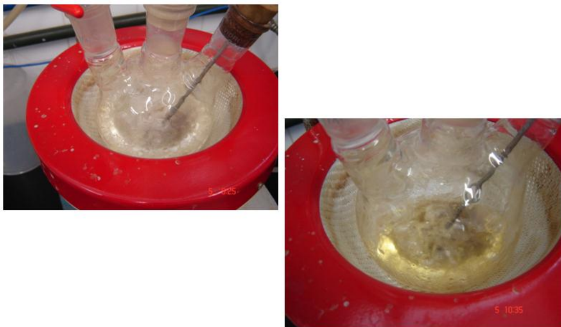
Figura 24: Formação de cor durante a evaporação a pressão ambiente.
