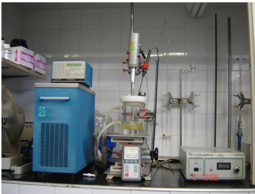
Figura 13: Arranjo experimental utilizado nos ensaios de cristalização
