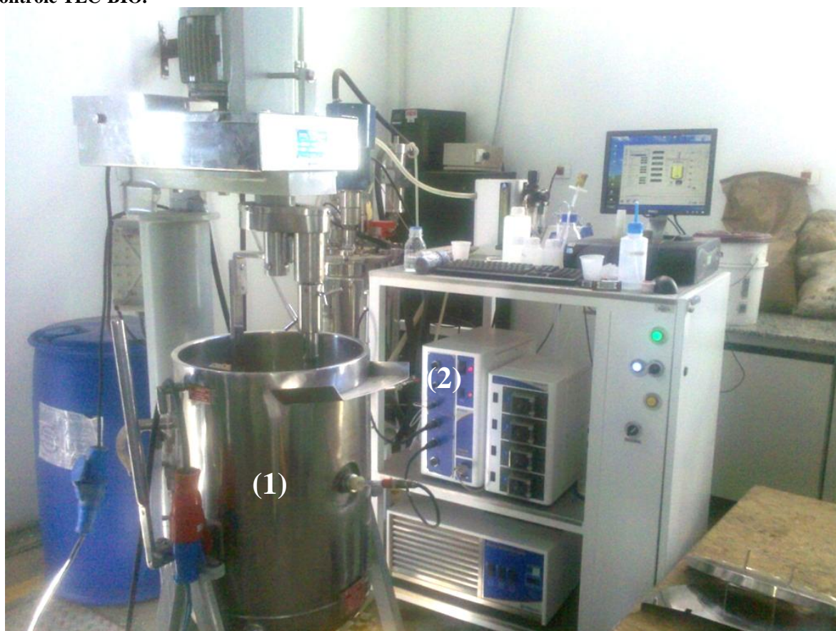
Figura 5.2 - Sistema piloto para hidrólise do SPC composto por : (1) bateadeira industrial e (2) módulo de controle TEC-BIO.
