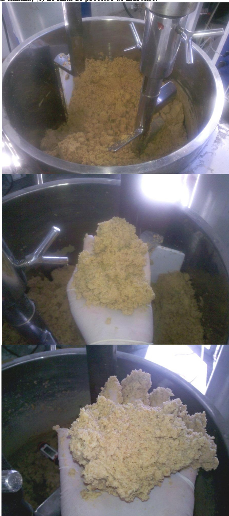
Figura 5.11 Hidrólise do SPC com 30% de sólidos. (a) após mistura do farelo com água e correção do pH; (b) após dosagem da enzima; (c) no final do processo de hidrólise.
