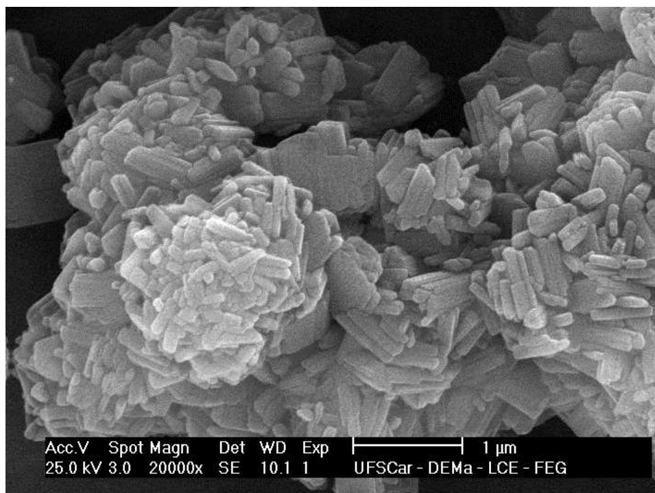
Figura 22 - Micrografia da zeólita MOR (ampliação 20000x).
