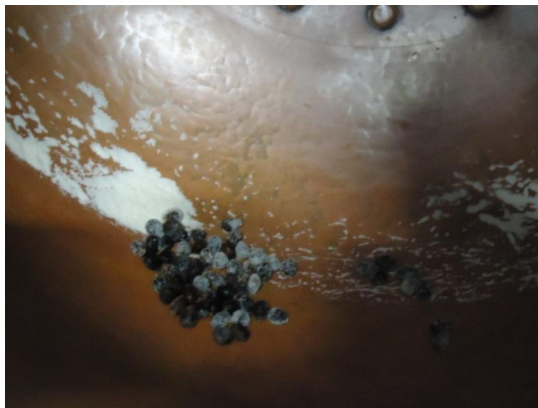
Figura 4-14 - Sementes de Mabea fistulífera Mart. sendo revestidas com alginato no interior da drageadora, na condição operacional com o ângulo de inclinação de 35° e rotação da panela em 35 rpm.
