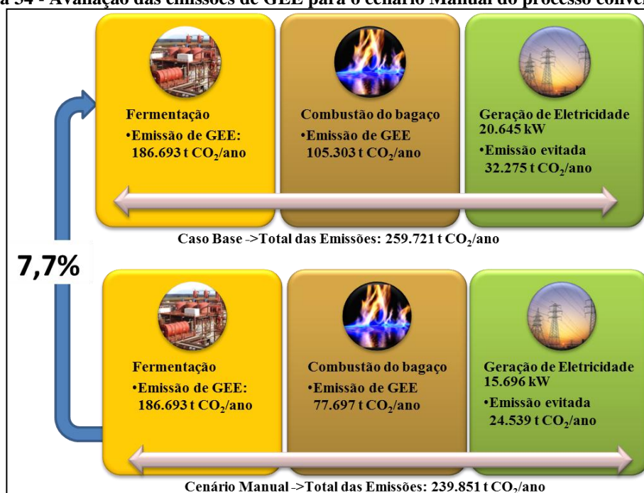
Figura 34 - Avaliação das emissões de GEE para o cenário Manual do processo convencional.
