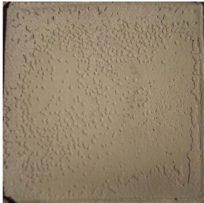
Figura 3.8: (a) Filtro com a torta de filtração após o primeiro ciclo de filtração e (b) filtro parcialmente limpo com velocidade de filtração igual a 5 cm/s, velocidade de limpeza de 10 cm/s e \Delta P_{\text{máx}} = 2939 Pa, mostrando claramente o fenômeno do patchy cleaning.
