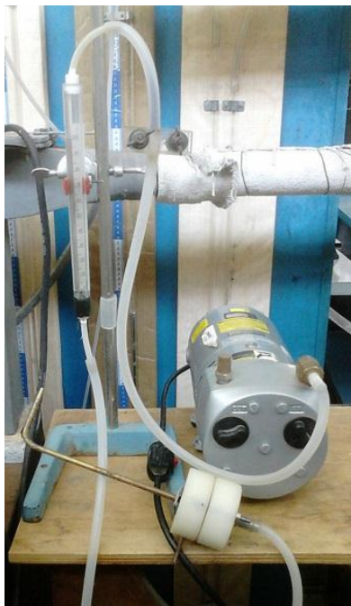
Figura 3.4 – Sistema de amostragem isocinética
