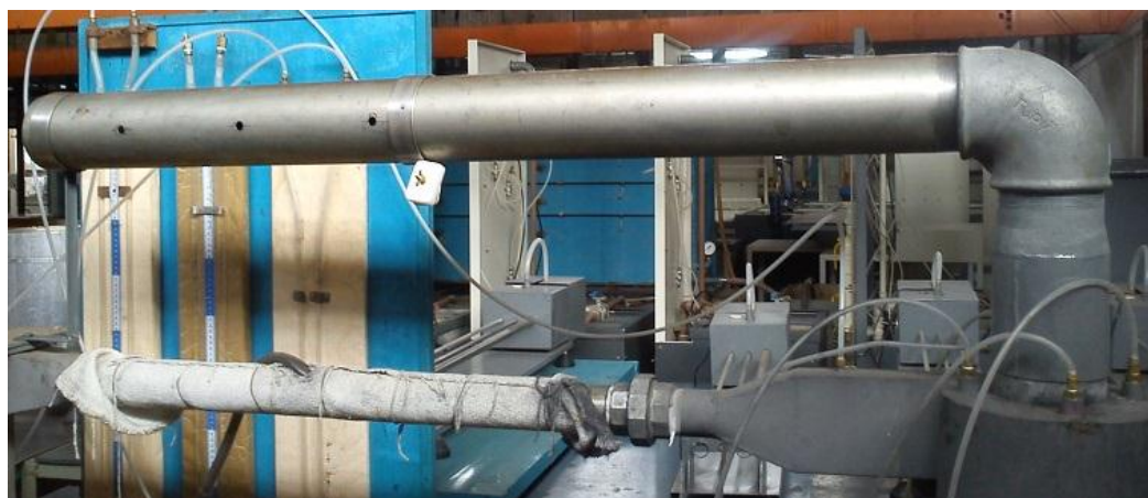
Figura 3.15 – Duto de saída de topo do ciclone
