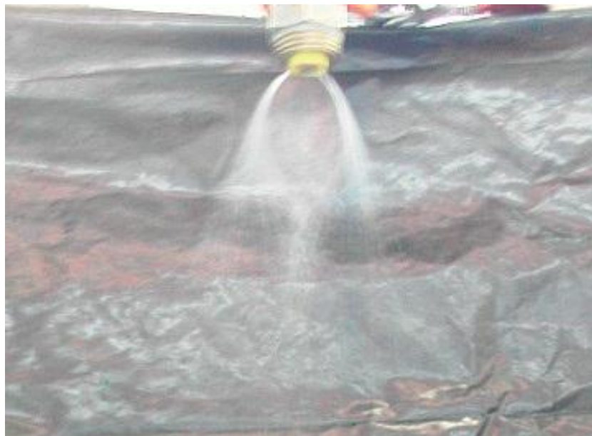
Figura 4.1 – Jato do bico injetor de água para a vazão de 28,9 L/h
