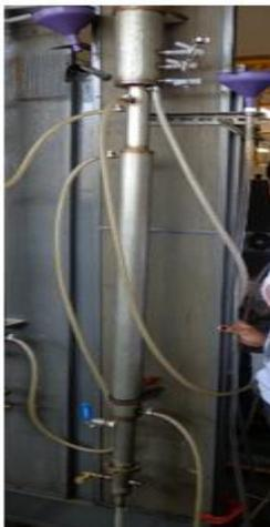
**Figura 4.3:** Reator anaeróbio de leito fluidificado termofílico
