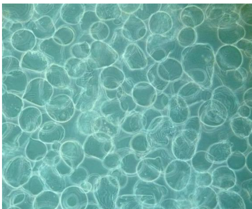
Figura 17 – Microesferas de alginato de cálcio com diâmetro entre 125 - 250 \mu\text{m} . Magnificação de 100x.
