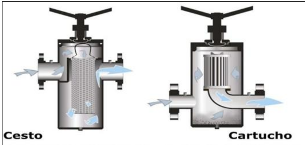
Figura 3.2. Separadores tipo cesto e tipo cartucho.
