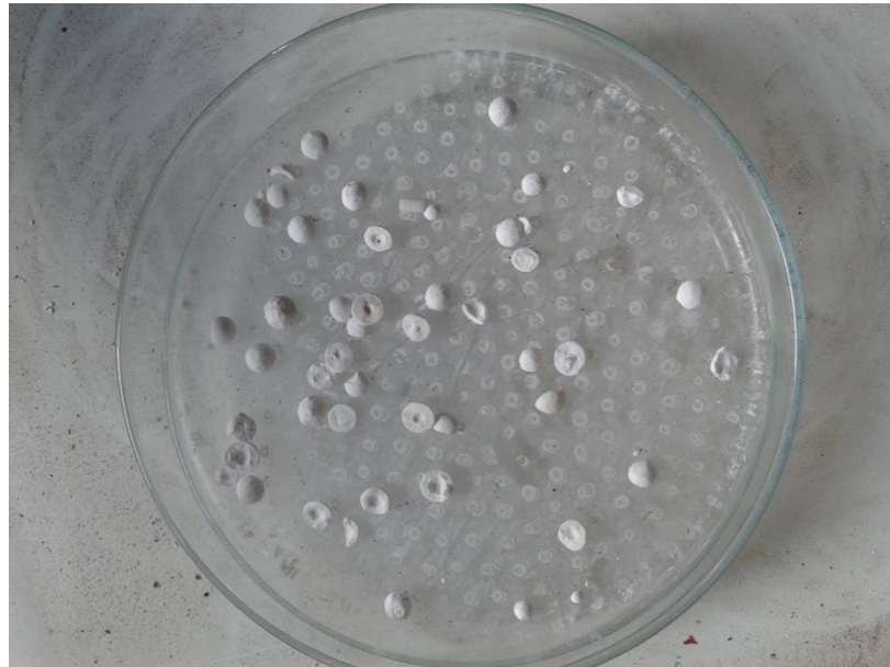
Figura 4.37: Partículas de alumina que foram secas utilizando A: 0,021m e f:6,8Hz
