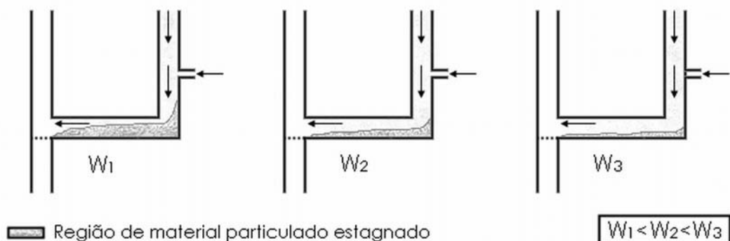
Figura 2.2 Comportamento dos sólidos através da válvula-L a diferentes vazões de sólidos
