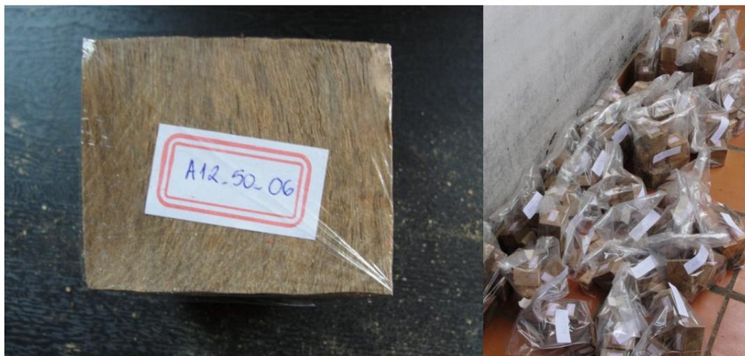
**Figura 3.19.** Corpo-de-prova etiquetado e sacos plásticos contendo corpos-de-prova separados por árvore e por seção.
