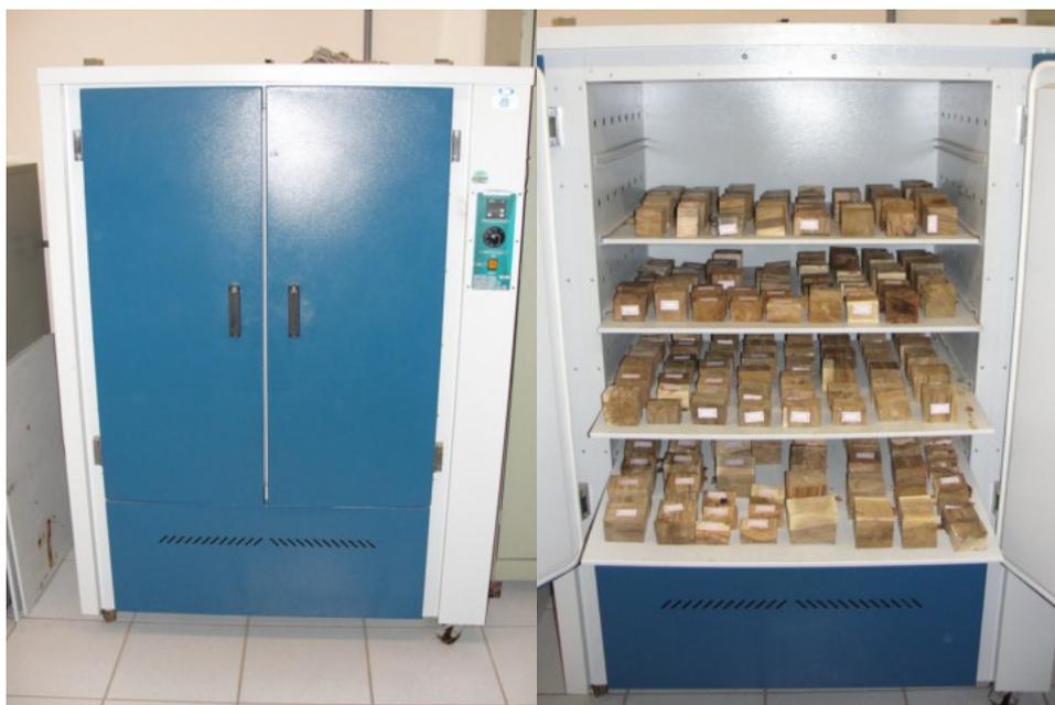
**Figura 3.22.** Estufa empregada para a secagem dos corpos-de-prova.
