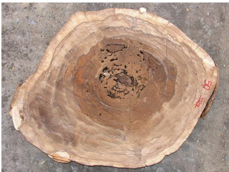
**Figura 2.6.** Presença de ataque de cupim em seção de madeira.
