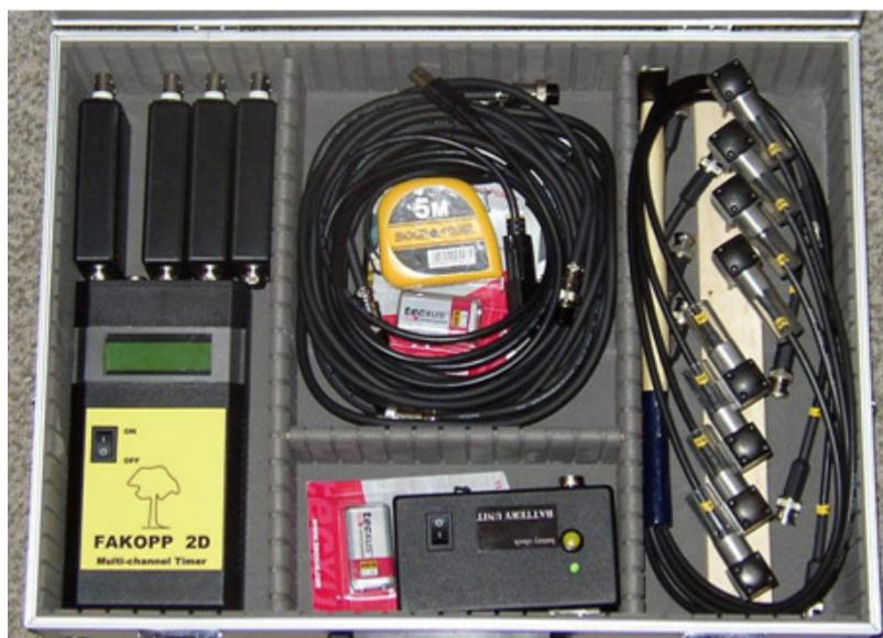
**Figura 3.3.** Equipamento de onda de tensão FAKOPP 2D.
