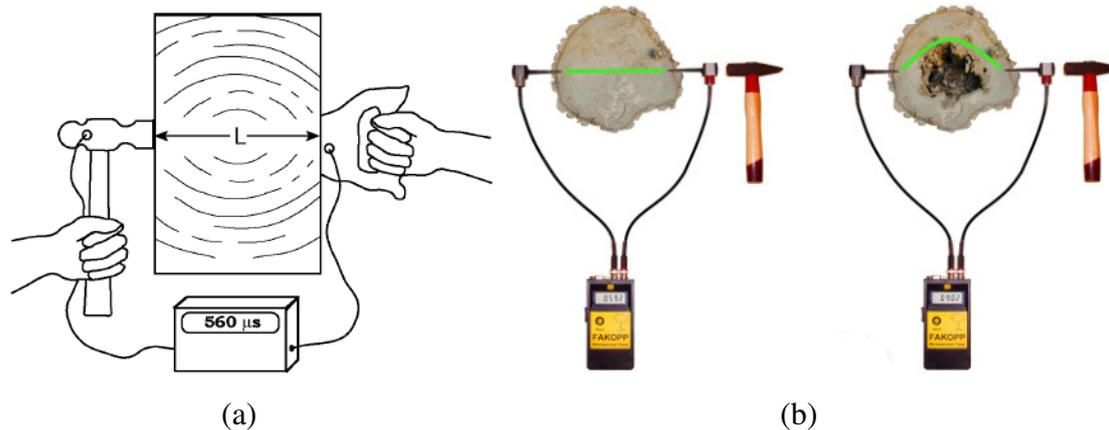
**Figura 2.8.** (a) Esquema de um ensaio de ondas de tensão. Fonte: Forest Products Laboratory (2000); (b) Esquema de funcionamento de equipamento de ondas de tensão<sup>3</sup>.
