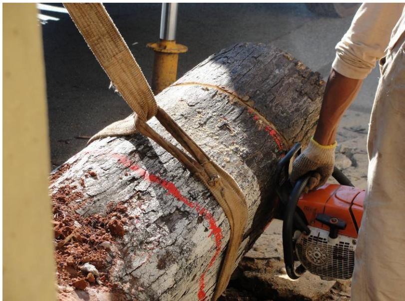
**Figura 3.11.** Corte da árvore nas seções ensaiadas.
