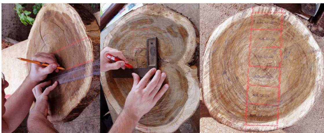
Figura 3.16. Demarcação dos corpos-de-prova.
