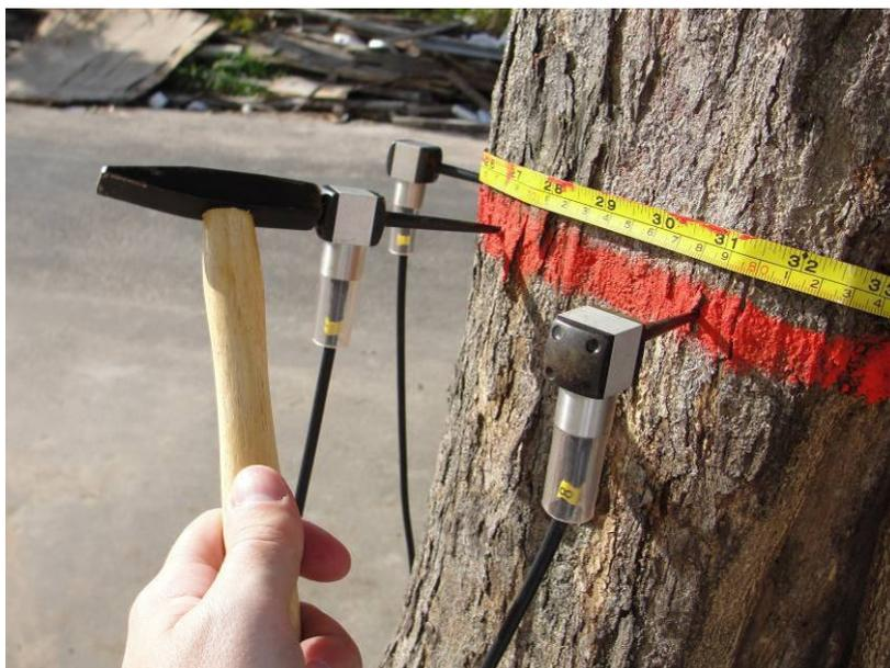
**Figura 3.5.** Aplicação de impulsos nos sensores para emissão das ondas.
