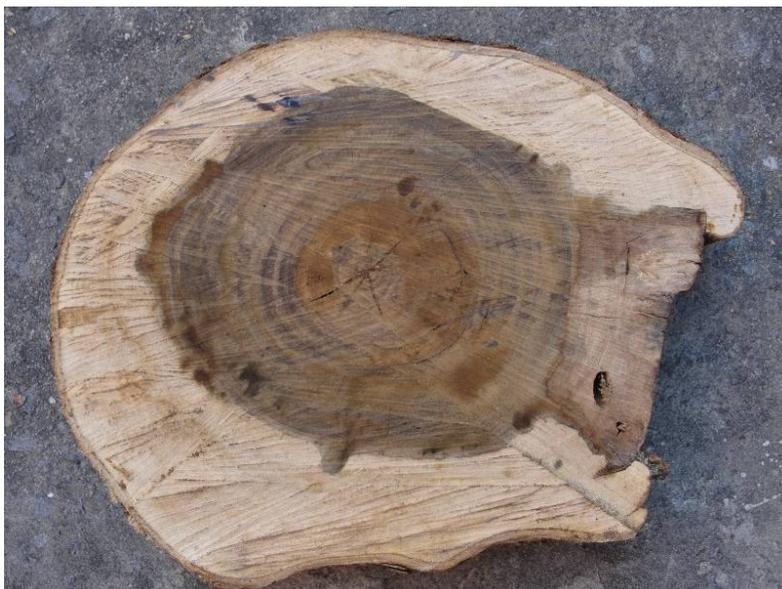
**Figura 2.5.** Presença de nó em seção de madeira.
