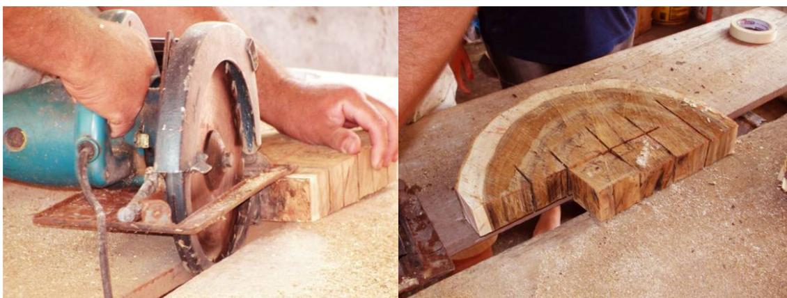
**Figura 3.18.** Retirada dos corpos-de-prova demarcados com utilização de serra de disco.
