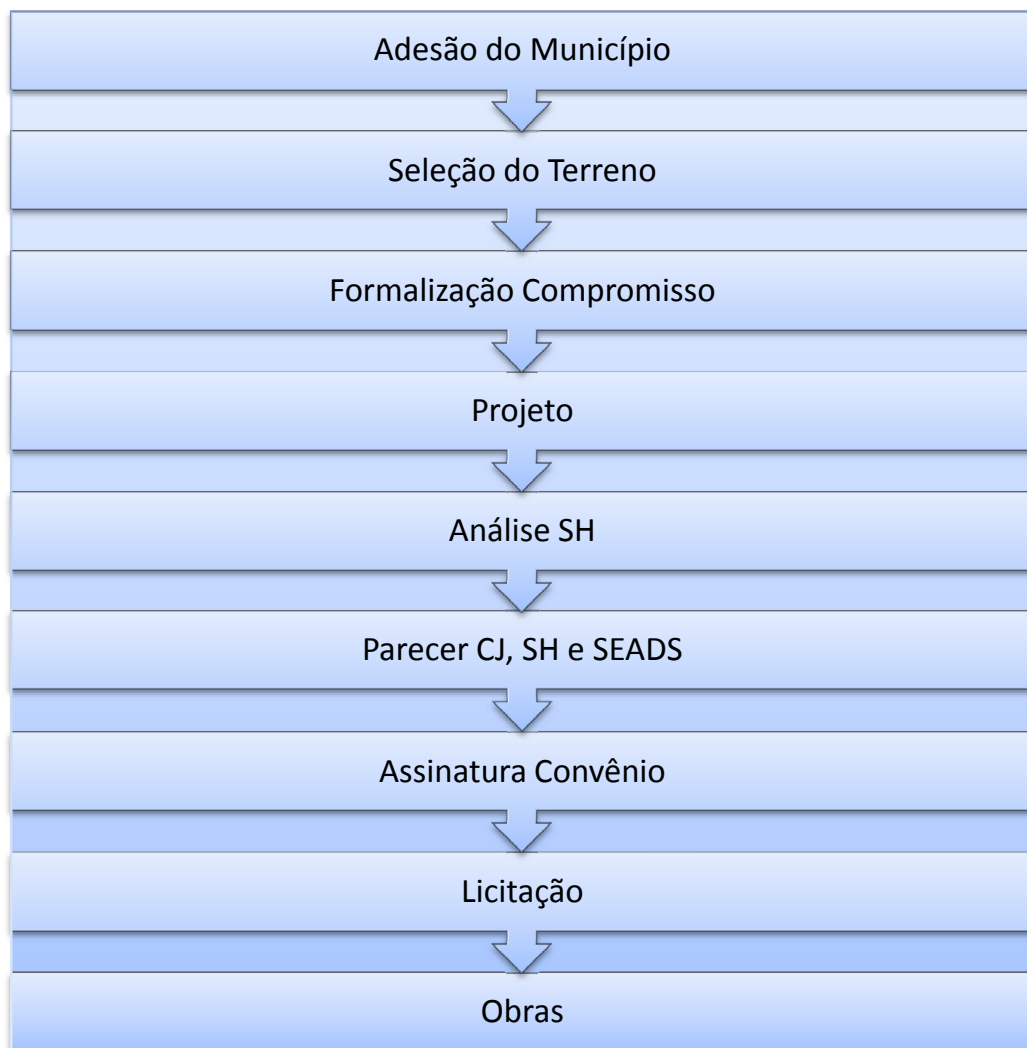
Quadro 4 – Etapas envolvidas no processo de implementação da obra de uma Vila Dignidade
