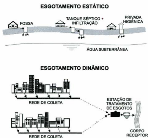
FIGURA 1. 4 – Esquema de sistema de esgotamento estático e dinâmico (Fonte: von SPERLING, 2005, p.53).
