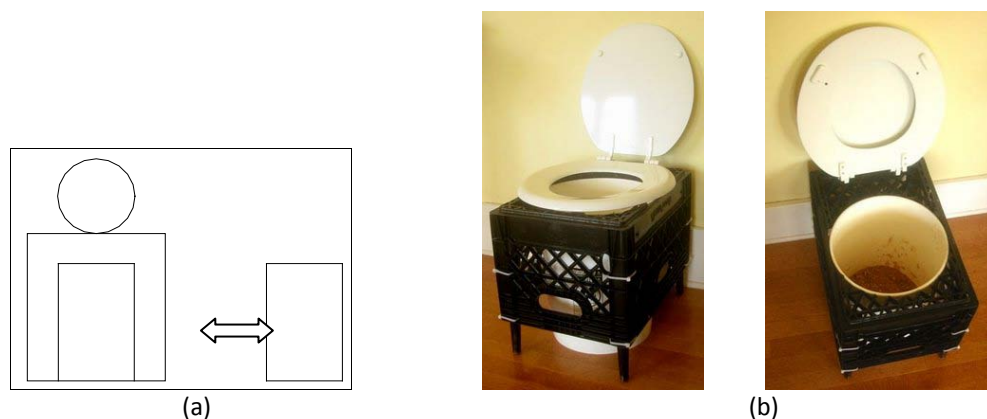
FIGURA 3. 22 – a) Esquema de funcionamento do banheiro seco com recipientes móveis / b) exemplo de banheiro seco recipientes móveis simplificado (Fonte: ERCOLE, 2003 e ROOF SIMPLE, 2009).
