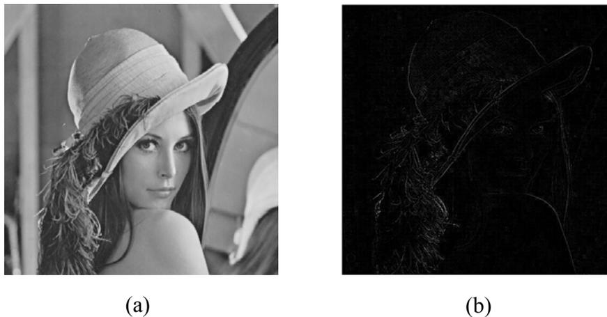
**Figura 22** – (a) Imagem Original (USC-SIPI *Image Database*, 1971), (b) Resultado obtido com a aplicação do filtro Laplaciano na imagem original.
