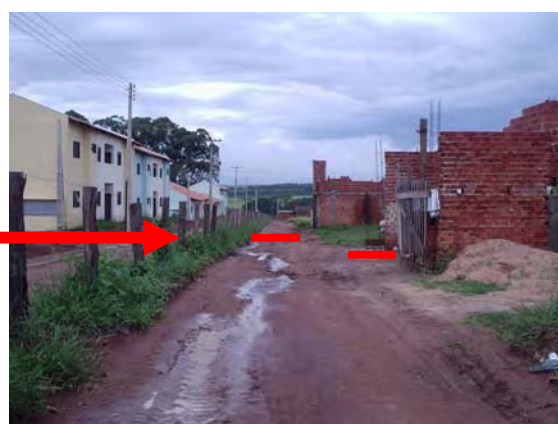
FOTOS B.4.12 e B.4.13. Falta de alinhamento. Invasão de construção na via de circulação (foto da autora).
