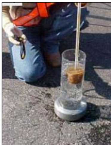
Figura 3.3: Drenômetro do Laboratório de Tecnologia de Pavimento da USP – SP. Fonte: APS, 2006, p. 36.
