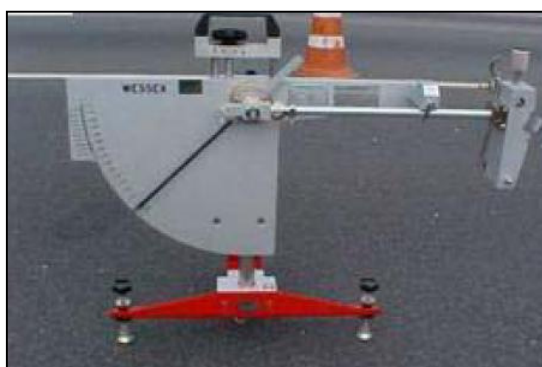
Figura 3.2: Pêndulo britânico Fonte: APS, 2006, p. 40.
