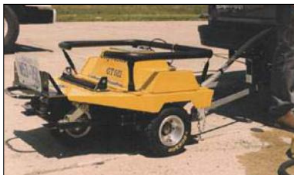
Figura 3.4: Grip Tester rebocável Fonte: APS, 2006, p. 50.
