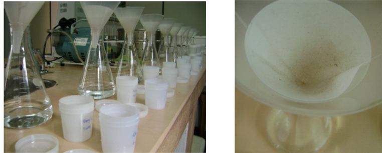
**Figura 22:** Filtração em laboratório. À esquerda, conjunto béquer-funil-papel filtro. À direita, detalhe do papel filtro dobrado. Sem escala.
