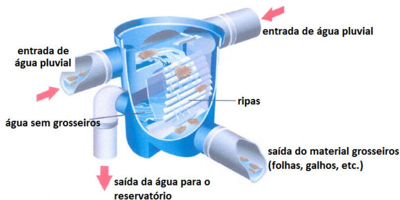
**Figura 2:** Separador de grosseiros utilizado em sistemas de aproveitamento de águas pluviais. Fonte: modificado de May (2004).
