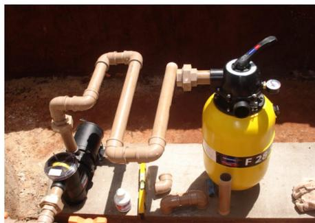
**Figura 14:** Fotografia do filtro de pressão utilizado no trabalho. Sem escala.
