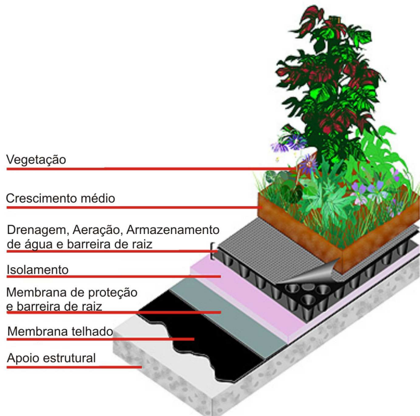
FIGURA 27 – Telhado verde em camadas. Fonte: Adaptado de Villanova Urban Stormwater Partinersi (disponível em: http://www3.villanova.edu/VUSP/bmp_research/green_roof/gr_roof_main.htm )
