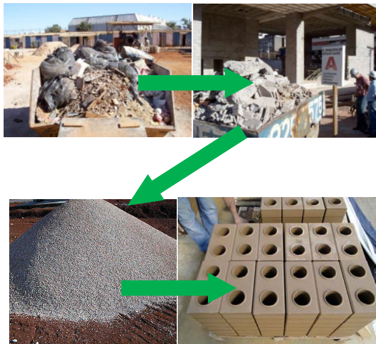
Figura 1. Fluxo de resíduos da construção civil: da geração à transformação em novos materiais de construção;
