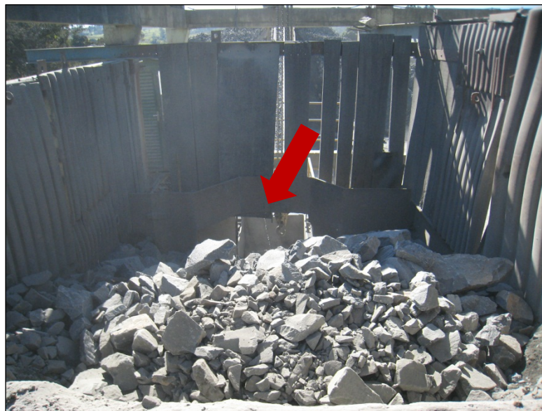
Figura 21 – Britador primário com detalhe do uso de água
