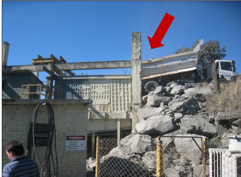
Figura 21 – Britador primário com detalhe do uso de água
