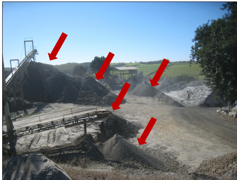
Figura 23 – Detalhes das pilhas de diferentes granulometrias
