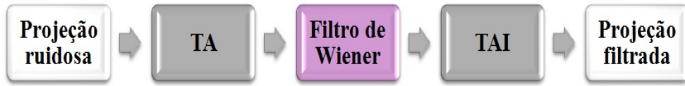
Figura 10: Passos para a filtragem das projeções utilizando o filtro de Wiener, TA representa a transformada de Anscombe e TAI a sua inversa.
