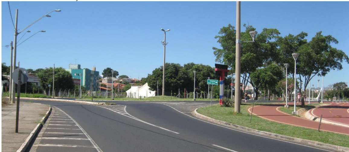
Figura 103 – Passeios e ciclovia com segregação espacial do lado esquerdo da via (ex. rotatória UBS Anchieta)
