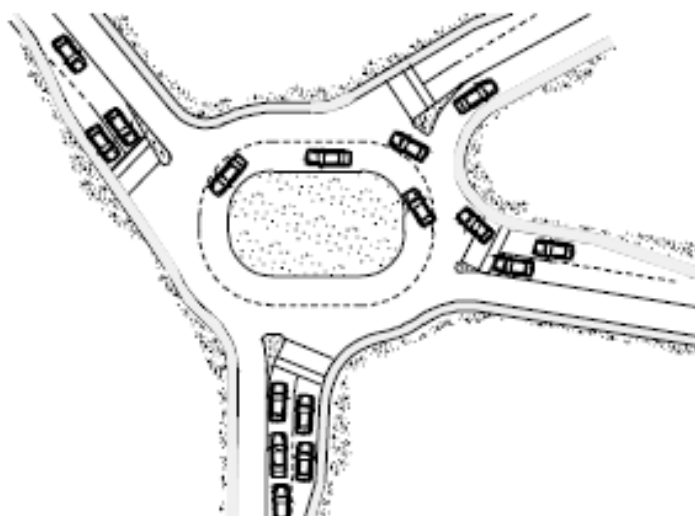
Figura 7 – Exemplo de Rotatória com alongamento da ilha central
