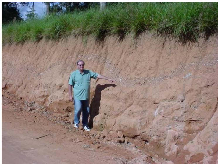
**FIGURA 41: Linha de seixo com presença de quartzo, separando solo residual e solo transportado, coordenadas UTM 7.596.767N e 344.765E.**
