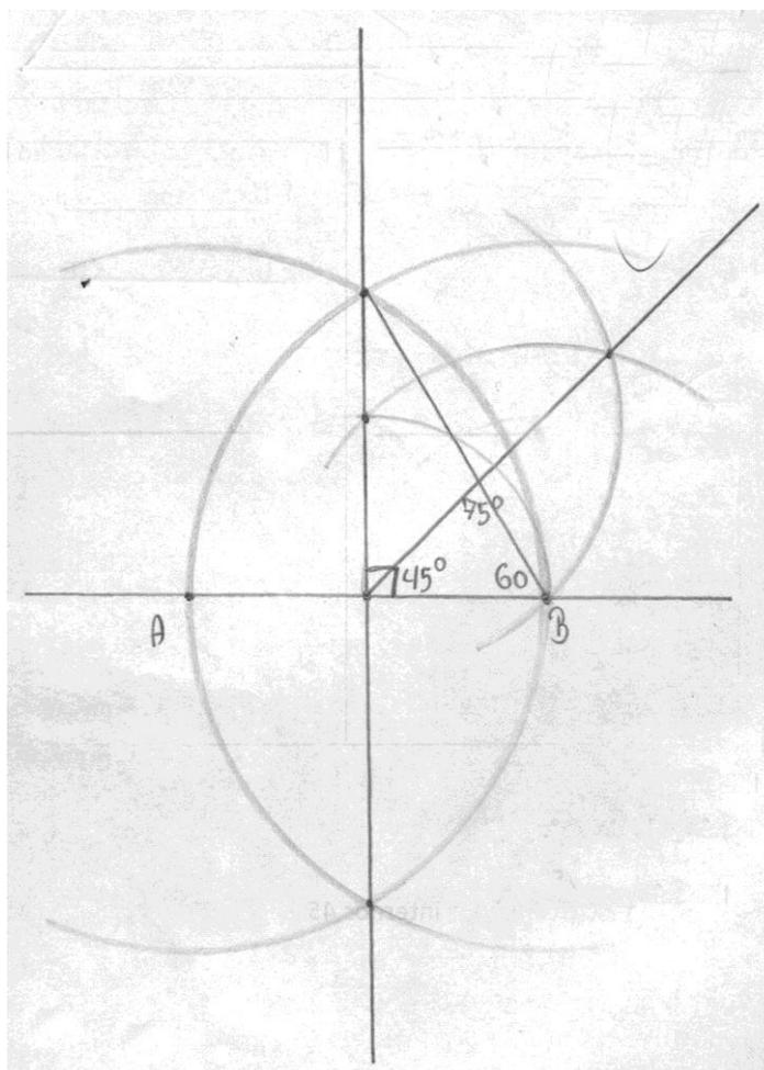
Figura 67 - Construindo o ângulo de  $75^\circ$  usando o Teorema Angular de Tales e as construções de ângulos com régua e compasso
