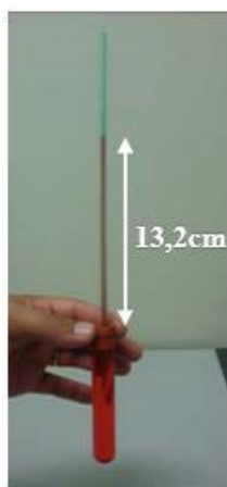
Figura 8 - Termômetro pronto com a coluna líquida (álcool) inicialmente na posição h_0 = 13,2\text{cm} .
