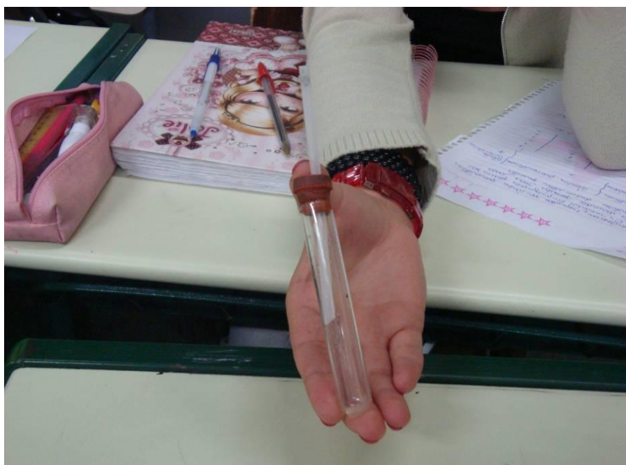
Figura 2 - Termômetro construído pelo grupo I (sem a substância termométrica).
