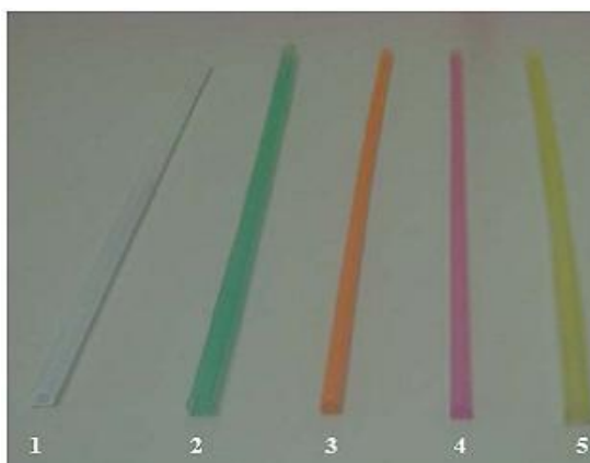
Figura 3 - Alguns tubos que, a princípio, podem servir como tubo capilar para o termômetro.
