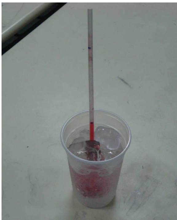
Figura 14 - Termômetro do grupo VII durante a calibração do primeiro ponto fixo.
