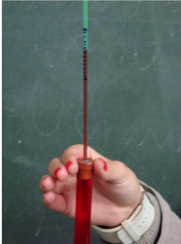
Figura 8 - Termômetro construído pelo grupo I registrando a temperatura ambiente.
