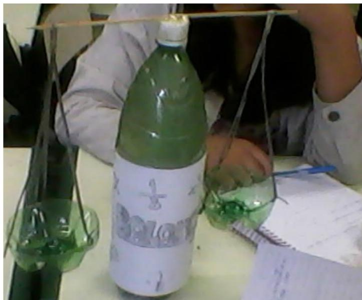
Foto 07 - Balança de dois pratos construída a partir de garrafas tipo "pet".
